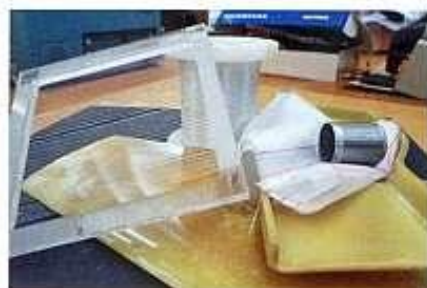
Рис. 7. Конструкционный тонкослойный радиопоглощающий материал на основе стеклоткани, содержащей нити с микропроводом
