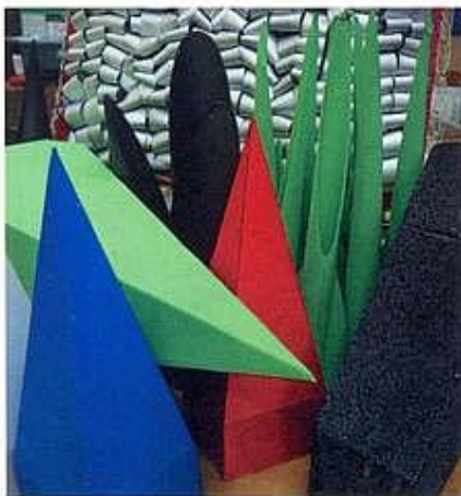
Рис. 1. Радиопоглощающие материалы для безэховых камер
