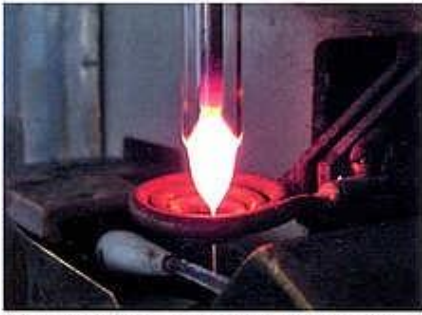
Рис. 3. Процесс плавления металла и катушки микропровода в стеклянной изоляции
