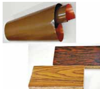
Рис. 3. Образцы экранирующих строительных отделочных материалов Fig. 3. Samples of Shielding Finishing Construction Materials
